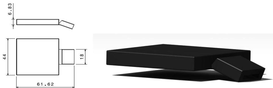
**DEPÓSITO:** Depósito para ser llenado de agua, útil para las funciones de salida de agua y vapor. Debido a su transparencia se puede ver la cantidad de agua disponible desde la parte superior.
