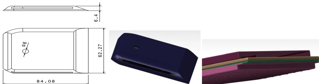
**PLACA:** Placa en la que, entre otros componentes, se encuentran las resistencias que generan el calor de la plancha.
